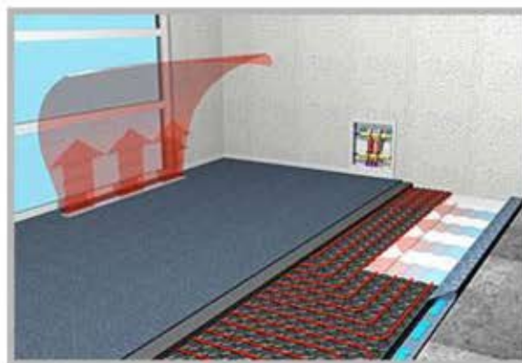
Figuur 3. Werking ClimaLevel vloersysteem in ruimte.
